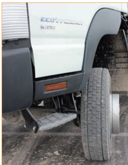
У полноприводной версии Canter 6С18 4x4 появилась дополнительная подножка кабины
