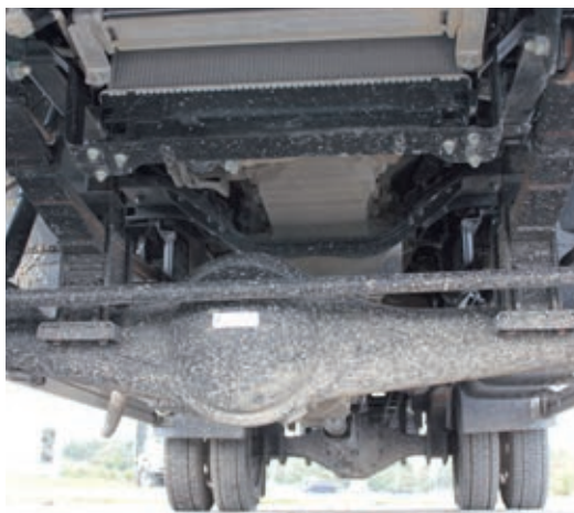
Максимальный дорожный просвет 320 мм, минимальный – 185 мм
