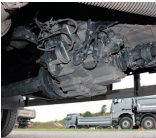
А это исполнительные механизмы внедорожного арсенала на картерах КП и раздаточной коробки
